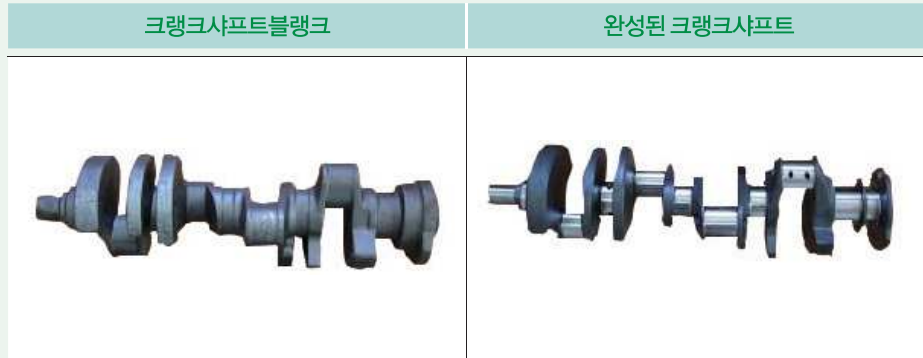
〈[그림7] 크랭크샤프트블랭크와 완성된 크랭크샤프트〉
